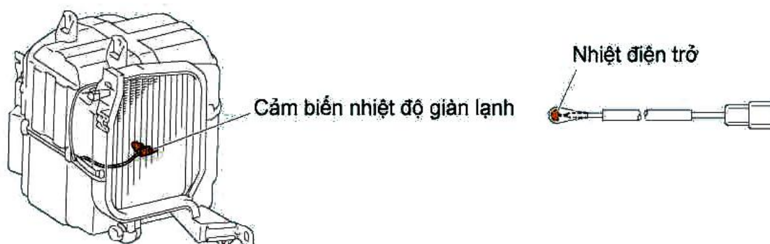
Hình 14.11: Cấu tạo cảm biến nhiệt độ giàn lạnh.
